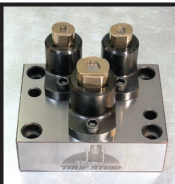
Unità standard adattate a un portapunzoni speciale esistente
